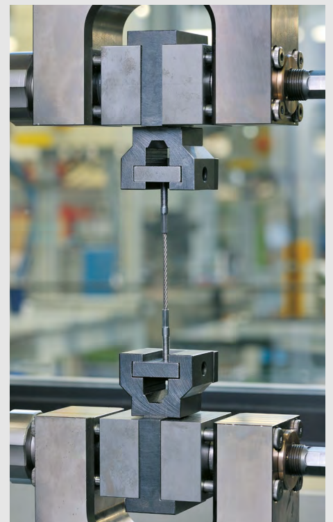
Zugprüfung von konfektionierten Seilen Tensile testing of assembled ropes
